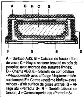
A = Surface ABS; B = Caisson de torsion fibre de verre; C = Noyau senséur breveté en bois de peuplier, avec ancrage des surfaces limites; D = Chants ABS; E = Semelle de compétition «P-tex downhill» avec affûtage à la pierre traitée au diamant; F = Carres «système bioflex» extra minces - d'où surface de glisse accrue; G = Alliage alu «Perradur S»; H = Double caisson de torsion; J = Carres supérieures «Perradur S»
