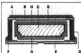
A = Surface ABS; B = Caisson de torsion fibre de verre; C = Noyau senseur breveté en bois de peuplier, avec ancrage des surfaces limitées; D = Chants ABS; E = Samolite de compétition «P-tex downhill» avec affûtage à la pierre traitée au diamant; F = Carres «système bioflex» extra minces - d'où surface de glisse accrue; G = Alliage alu «Perradur S»; H = Double caisson de torsion; J = Carres supérieures «Perradur S»
