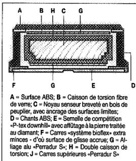
A = Surface ABS; B = Caisson de torsion fibre de verre; C = Noyau senseur breveté en bois de peuplier, avec ancrage des surfaces limites; D = Chants ABS; E = Semelle de compétition «P-tex downhill» avec affûtage à la pierre traitée au diamant; F = Carres «système bioflex» extra minces - d'où surface de glisse accrue; G = Alliage alu «Perradur S»; H = Double caisson de torsion; J = Carres supérieures «Perradur S»
