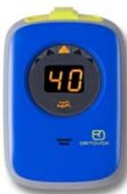
Après la première version du boîtier, celui-ci est corrigé dans sa version 13/14, la pile ne pouvant plus sortir par accident.
