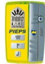
Le système DSP permet au microprocesseur, grâce à un algorithme spécialement conçu, d'isoler chaque signal en fonction de son « identité » propre. C'est notamment grâce au DSP que le DVA est en mesure d'établir une liste des victimes – certains appareils peuvent même suivre un signal au choix – masquer un signal lorsque le sauveteur le lui demande pour se concentrer sur le prochain, ce qui permet de résoudre les situations de victimes multiples beaucoup plus facilement.
