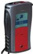
Il est suivi en 2006 par le Pulse Barryvox, toujours du tandem Ascom/Mammut, premier appareil tri-antenne analogique et numérique, également équipé du système DSP. Le Pulse reçoit un Award à l'ISPO de Munich en février 2007 pour son côté innovant et son design.
